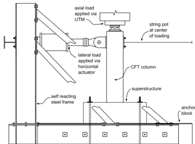
Fig. 9 Test apparatus
